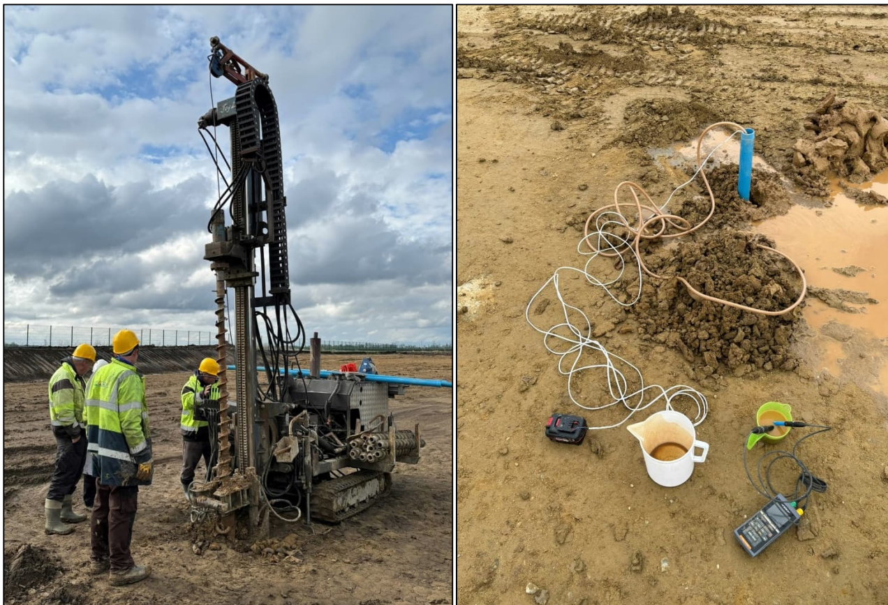
33. ábra: Mintavételi furat kialakítása (balra), tisztító szivattyúzás és terepi mérés felszín alatti vízmintavétel előtt (jobbra)
